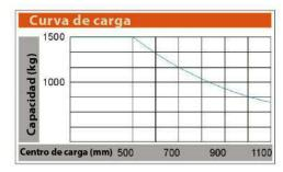
NOTA: Diagrama de carga con hoiorquillas standard y centro de gravedad 500 mm. Si utiliza otras horquillas y/o centro de carga diferente, consulte al fabricante.
